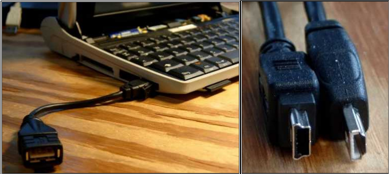
Der USB-Adapter und die USB-Mini-Stecker im Vergleich (rechts vom NETBOOK PRO, dabei soll es sich laut Online-Handbuch um einen USB-Mini-Stecker Typ A handeln, ist der Standard dann ein Typ B ?)
