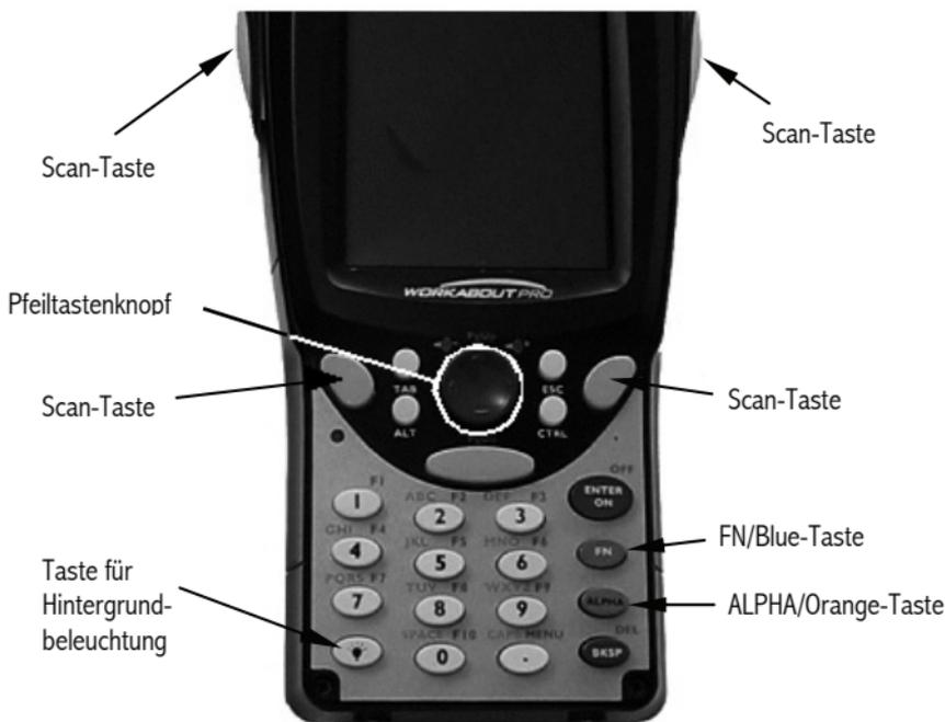
Die Tastatur ist mit einer Reihe von Standardtasten und den Modustasten <ORANGE> und <BLUE> ausgestattet, um auf zusätzliche Tasten- und Systemfunktionen zugreifen zu können. Diese Funktionen sind in einem farbigem Code, in *orange* und *blau*, über den Tasten der Tastatur aufgedruckt.
